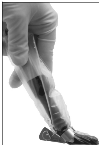
Obr. 7. Snímač 8809 se sterilním návlekm snímače a punkční nástavec UA 1262
