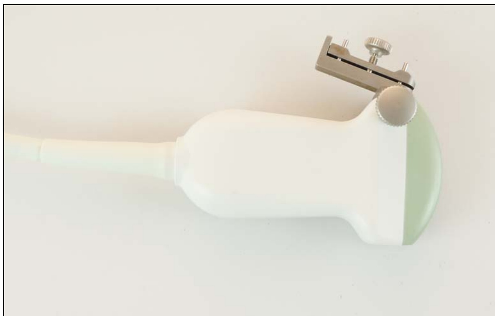
Obrázek 3. Snímač 9C2 s namontovaným nástavcem UA 1250.
